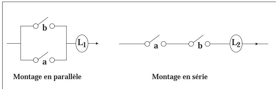
Notons  $a = 1$  l'état où l'interrupteur  $a$  est fermé (et le courant circule) et  $a = 0$  l'état contraire. Même chose pour  $b$ .
